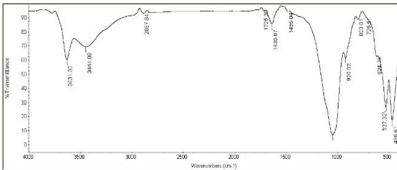
Fig. 11 FTIR spectrum of Cloisite Na<sup>+</sup>
