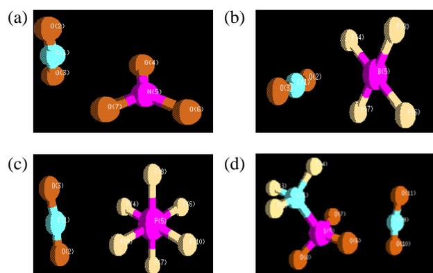
Fig. 2 Minimum energy structures of different anion-CO<sub>2</sub> complexes (a) NO<sub>3</sub><sup>-</sup> (b) BF<sub>4</sub><sup>-</sup> (c) PF<sub>6</sub><sup>-</sup> (d) CF<sub>3</sub>SO<sub>3</sub><sup>-</sup>
