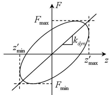
$$k_{dyn} = \frac{F_{max} - F_{min}}{z'_{max} - z'_{min}}$$
